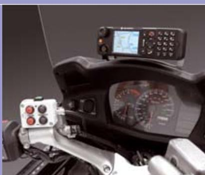
Contrôler la radio à partir d'équipements externes (comme la boîte de commande à côté du guidon) permet à l'utilisateur de changer de groupe et de modifier le volume sans difficulté.
